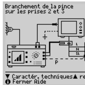
P : câble de potentiel pour mesure quadripolaire.
