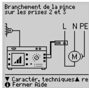
Avec un convertisseur d'intensité ou de tension à pince connecté aux bornes 2 et 3, tel que p. ex. WZ12C, vous pouvez mesurer des courants alternatifs sur deux plages de mesure (1 mA ... 10 A ~, 1 A à 100 A~).
