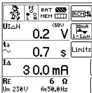
Si un RCM est utilisé en association avec un dispositif de commande externe, cette combinaison doit être contrôlée à la manière d'un RCD.
