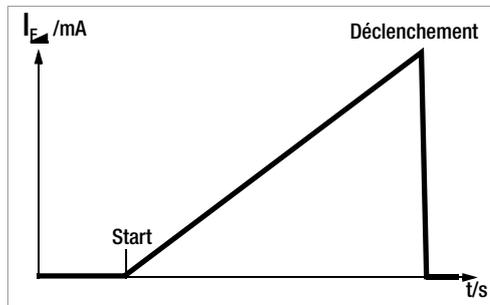
Si le sélecteur est sur  $I_F$ , un courant continu à ascension lente circule par N et PE. La valeur instantanée de l'intensité mesurée s'affiche en permanence. Au déclenchement du disjoncteur RCD, la dernière
