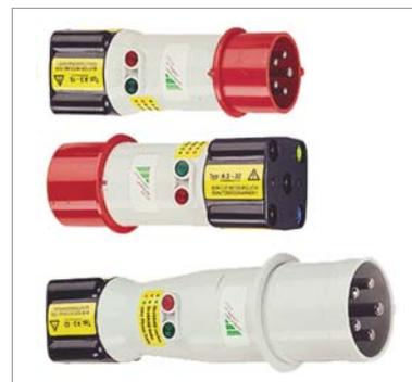
Les adaptateurs de courant triphasé A3-16, A3-32 et A3-63 servent à connecter des appareils de contrôle aux prises CEE à 5 pôles. Les 3 modèles se distinguent par la taille du connecteur qui correspond aux prises CEE à 5 pôles avec courants nominaux de 16 A, 32 A, 63 A. L'ordre des phases est signalé par des témoins lumineux. Le contrôle de
