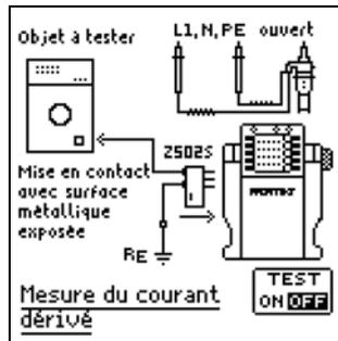
En conformité avec les prescriptions citées ci-dessus, cet adaptateur de mesure permet de mesurer des courants jusqu'à 10 mA.
