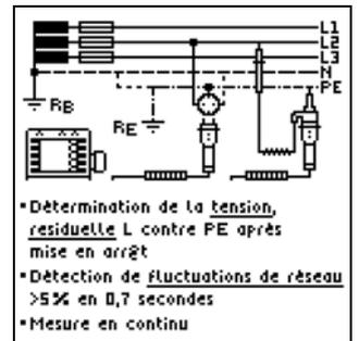
En cas de coupure de tension de plus de 5 % (en 0,7 s) de la tension de réseau momentanée, le chronomètre est démarré et au bout de 5 s, la sous-tension momentanée est affichée par Ures et signalée par la diode rouge UL/RL.
