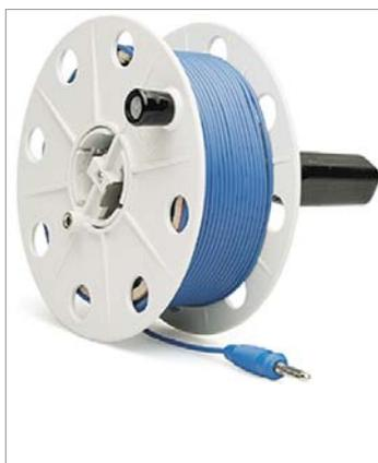
Cordon de mesure de 50 m, enroulé sur un tambour en matière synthétique. Le raccordement à l'une des extrémités du cordon de mesure est possible par une prise intégrée à la bobine. L'autre extrémité est dotée d'une fiche banane. L'axe de la bobine est équipé d'une poignée démontable. La bobine est ainsi peu encombrante pour le rangement. Le taux de résistance du câble peut être compensée en position  $R_{LO}$  du sélecteur.
