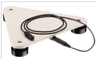
La sonde de sol 1081 permet de mesurer la résistance des sols isolants selon DIN VDE 0100 partie 600 et EN 1081.
