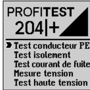
Le réglage de la valeur limite de la résistance du conducteur de protection s'effectue à l'aide de la section du câble des conducteurs extérieurs L et N éventuellement, et non au moyen de la section du conducteur de protection PE. Ceci est rendu nécessaire puisque câble et conducteurs présentant des sections de conducteur extérieur supérieures à 16 mm<sup>2</sup> sont dotés d'un conducteur de protection de section réduite et que le choix à l'aide de la section PE serait alors équivoque.
