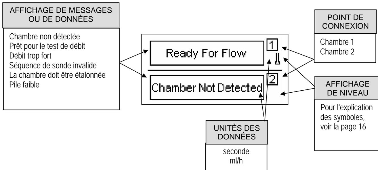
**ÉCRAN DES CONNEXIONS** – L'écran des connexions présente la disposition des connexions en haut de l'écran du SECULIFE IF+ ainsi que la capacité volumique de chaque chambre connectée.
