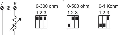
Anschluss als Potentiometer (3-Draht)
