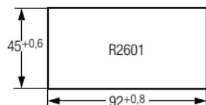
Figure 2, Dimensions du boîtier et de la découpe dans le tableau de commande
