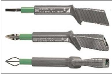
Trois pointes de touche à accrochage protégées contre les contacts accidentels pour connecter des cordons de mesure équipés de fiches bananes de 4 mm ou de fiches protégées contre les contacts accidentels à des prises dotées d'ouvertures de 3,5 à 12
