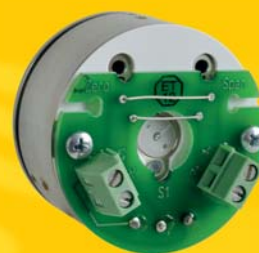
Empreinte de raccordement avec bornes à vis
