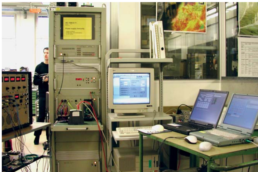
Mesure du comportement des appareils en cas de chute de tension, de brèves interruptions ou de variations de tension de l'alimentation auxiliaire
