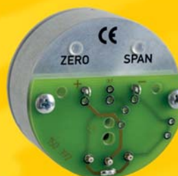
Empreinte de raccordement avec soudures
