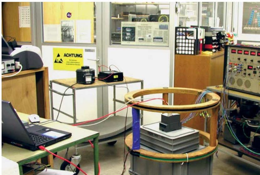
Détermination du comportement de l'appareil sous l'influence d'un champ magnétique étranger, produit par une bobine de Helmholtz
