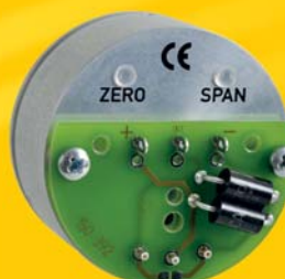
Empreinte de raccordement avec diode Trans-Zorb
