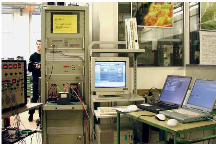
Meting van het gedrag van de apparatuur bij spanningsdips, korte onderbrekingen of spanningsfluctuaties van de voedingsspanning
