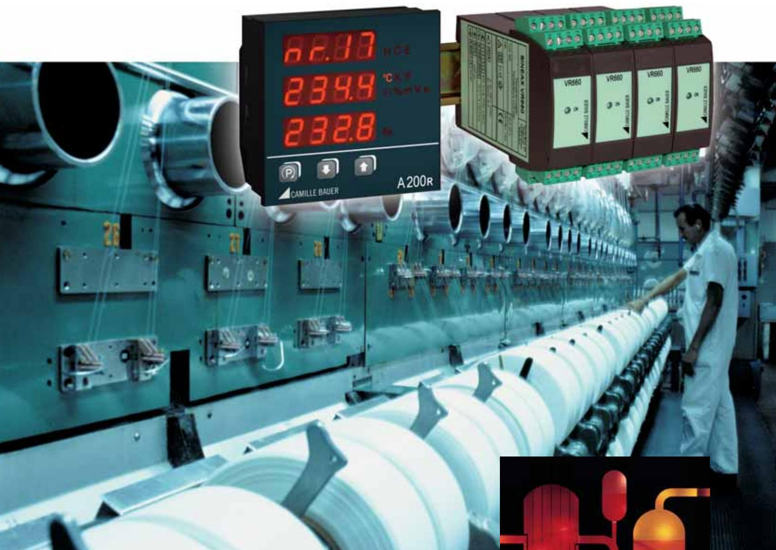
Construit selon le principe modulaire, le système de régulation de température de Camille Bauer offre la plus grande flexibilité pour une fonctionnalité maximale. L'utilisateur dispose, en fonction de ses exigences, d'1 à 32 circuits régulateurs, reliés les uns aux autres par un bus interne. L'unité de visualisation (A200R) associée permet une commande in situ.
