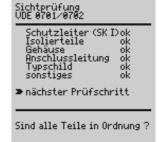
⇒ Führen Sie den nächsten Prüfschritt aus: Taste ◄. (Der Cursor muss hierzu in der Zeile "nächster Prüfschritt" stehen.)
