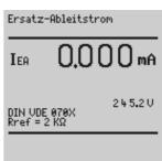
stellt oder an eine von Erde isolierte Spannungsquelle angeschlossen werden müsste. Der Grenzwert beträgt 3,5 mA.
