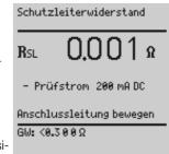
Der Widerstand wird zwischen dem Schutzleiteranschluss an der Prüfdose bzw. an der Buchse SL und dem Sondenanschluss am Prüfling (Berührung leitfähiger Teile des Gehäuses) gemessen.
