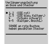
Es darf pro Prüfdurchgang nur jeweils 1 Verlängerungsleitung angeschlossen und geprüft werden.
