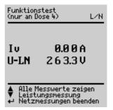
Mit der Taste (11) kann die Prüfdose spannungsfrei geschaltet oder mit der Taste 🗗 der Funktionstest beendet werden.
