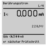
Nach der Messung: Schalten Sie den Prüfling aus.
