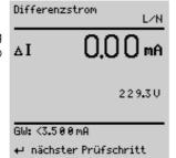
schluss eines Gerätes durch die Leiter L und N fließen (wird auch Reststrom genannt). Der Differenzstrom ist im Fehlerfall mit dem Fehlerstrom praktisch identisch. Fehlerstrom: Strom, der durch einen Isolationsfehler verursacht wird und über die Fehlerstelle fließt.
